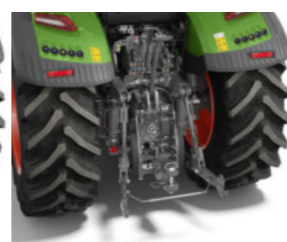
Sollevatore posteriore con attacchi rapidi e Rub Blocks (AU, Sudafrica, Europa dell'Est)
